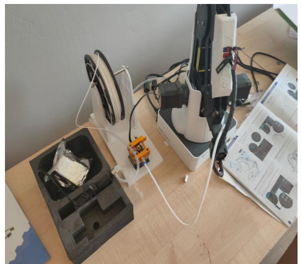
5. «Dobot Magician» (Добот Магикан) – четырех осевой учебный робот-манипулятор с модульными сменными насадками – 1 шт.
